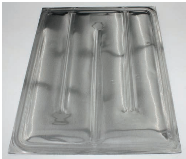
EMPT geschweißte Kühlplatte (Segment) für Batteriekästen von neuen Elektrofahrzeugen
