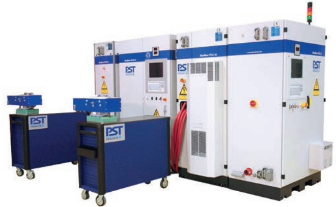
EMPT Anlage mit einer Werkzeugspule (Vordergrund), Kondensatorschrank und Steuerschrank (im Hintergrund von li. nach re.)
